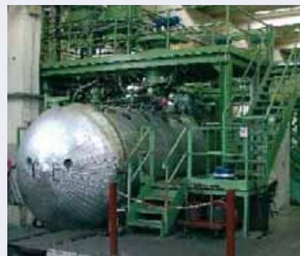
Sistema de vertido a alto vacío.
