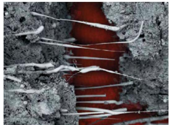
Fibras de Vidrio dentro del alma de yeso de una placa Glasroc F (Stuclal)
