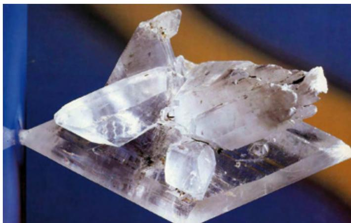
El yeso tiene una gran resistencia al fuego y es incombustible. Garantiza pues una buena protección en caso de incendio. Bajo la acción del calor, el yeso sólo evapora agua contenida en sus poros, por lo tanto en ningún caso desprende gases ni vapores de carácter tóxico.
