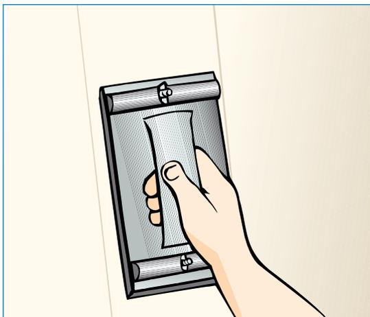
No se recomienda el lijado mecánico, ya que puede dañar la celulosa adyacente a la Pasta de Juntas. Además, puede eliminar excesivamente la pasta del tratamiento de juntas, dejando desprotegida a la cinta de papel, ocasionando problemas en el acabado de la decoración posterior.
