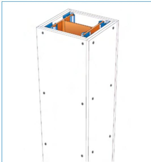
Cuando la altura del pilar sea superior a la de la longitud de la placa, en la junta horizontal creada, se colocará una lambeta de placa Glasroc F 13 para asegurar la continuidad de la protección.
