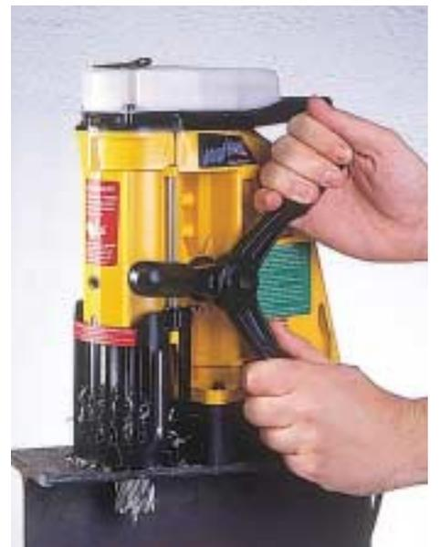
Robusto ultra compacto (279 mm de altura). Potente 1200W. Ligero: 13 Kg. Parrilla de protección de la herramienta regulable. Capacidad de taladro: 50 mm con fresa, 23mm con broca. Profundidad de taladro: 160mm
