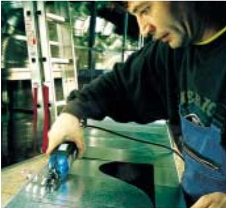
Cizalla que no deforma la chapa, permitiendo un seguimiento preciso del trazado. Separador de virutas de todos los recortes interiores. Grosor máximo de la chapa: acero 1mm; inox 0.8mm; aluminio 1.2mm. Velocidad de trabajo 6-10 m/min. Potencia del motor 350W.
