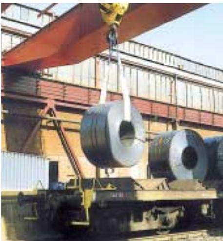
100% poliéster. Doble vaina con compartimentos cada 40 mm, hilos de trama indicando la carga. Conforma a la norma EN 1492.2
