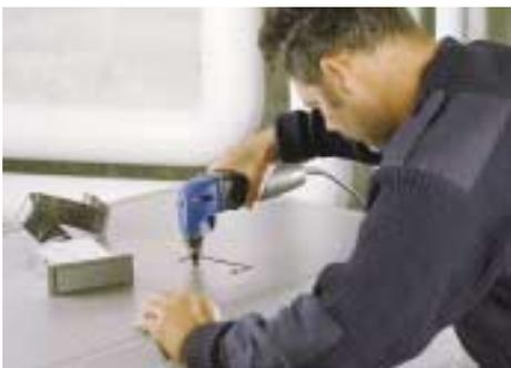
Nueva generación para el recorte manual. Mucho más polivalente gracias al nuevo sistema de montaje y desmontaje de las herramientas, sin llave. Capacidad de corte en acero (400 N/mm<sup>2</sup>): 2 mm. Radio mínimo 4 mm. Motor 500 W. Peso 2.2 Kg.
