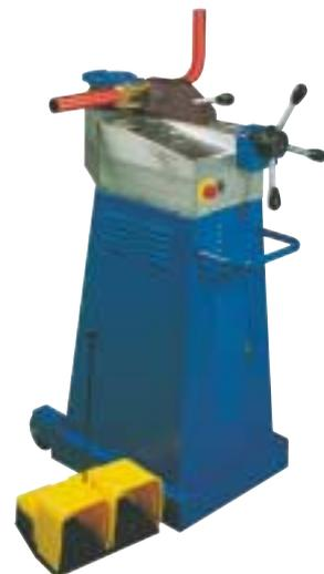
Fácil utilización. Capacidad máxima hasta un diámetro 60x1.5mm según el tipo de material/producto.
