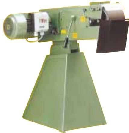
bandas abrasivas 2000x75mm y 2000x150mm, motor 3x230/400V. Potencia 5.5 HP. Rueda de contacto 200x75mm, rueda de arrastre 200x75 mm, plataforma de lijado 75x430mm. Nivel acústico 78 DB. Aspirador opcional.
