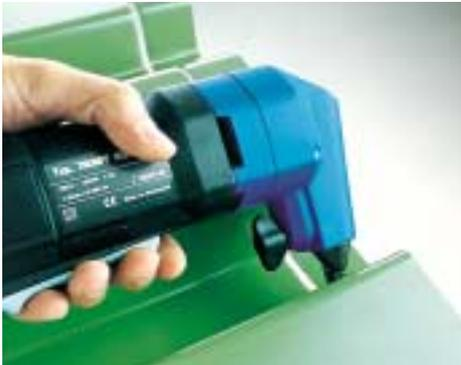
Pequeña máquina manejable para el recorte de depósitos de acero que no deforma ni quema la pintura.
