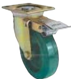
Montura de chapa de acero galvanizado. Pivotante sobre dos coronas de bolas de acero. Fijación a pletina fija y pivotante. Bloqueo con doble efecto sobre la rueda y el pivote. Rueda cuerpo de plástico.
