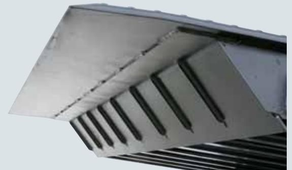
La uña retráctil de la chapa lagrimada de 12/14 mm de espesor también se fabrica de una sola pieza. El canto delantero especialmente estable está reforzado de forma continua y dotado de unas ranuras en las que se sueldan las jácenas. Así, el peligro de que la uña retráctil sufra daños debido a un manejo o a un apoyo incorrectos se puede minimizar en la mayor medida.
